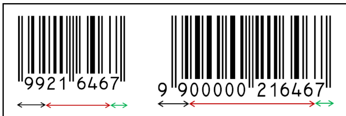
Figura 52: esquema simplificado de las partes de los símbolos EAN.
