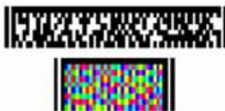
Figura 48: es de dominio público. El símbolo se compone de una tira de longitud variable de columnas de píxeles. La simbología utiliza pares de columnas verticales de cualquiera de las siete células blanco y negro y 8 multicolores, normalmente blanco, rojo, verde y azul o cian, magenta, amarillo y negro. Es un híbrido entre 1D y 2D, aunque utiliza un sistema de corrección redundante con muchos niveles basado en el algoritmo de Reed Solomon. Se trata de una nueva generación de códigos de alta capacidad. No están teniendo el éxito esperado por lo que están poco extendidos.
