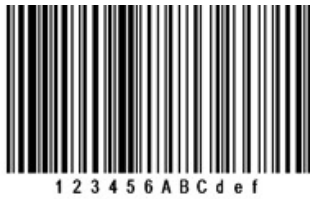
Figura 45: tienen una longitud fija. Permiten incluir los 12 dígitos en un espacio razonablemente compacto.
