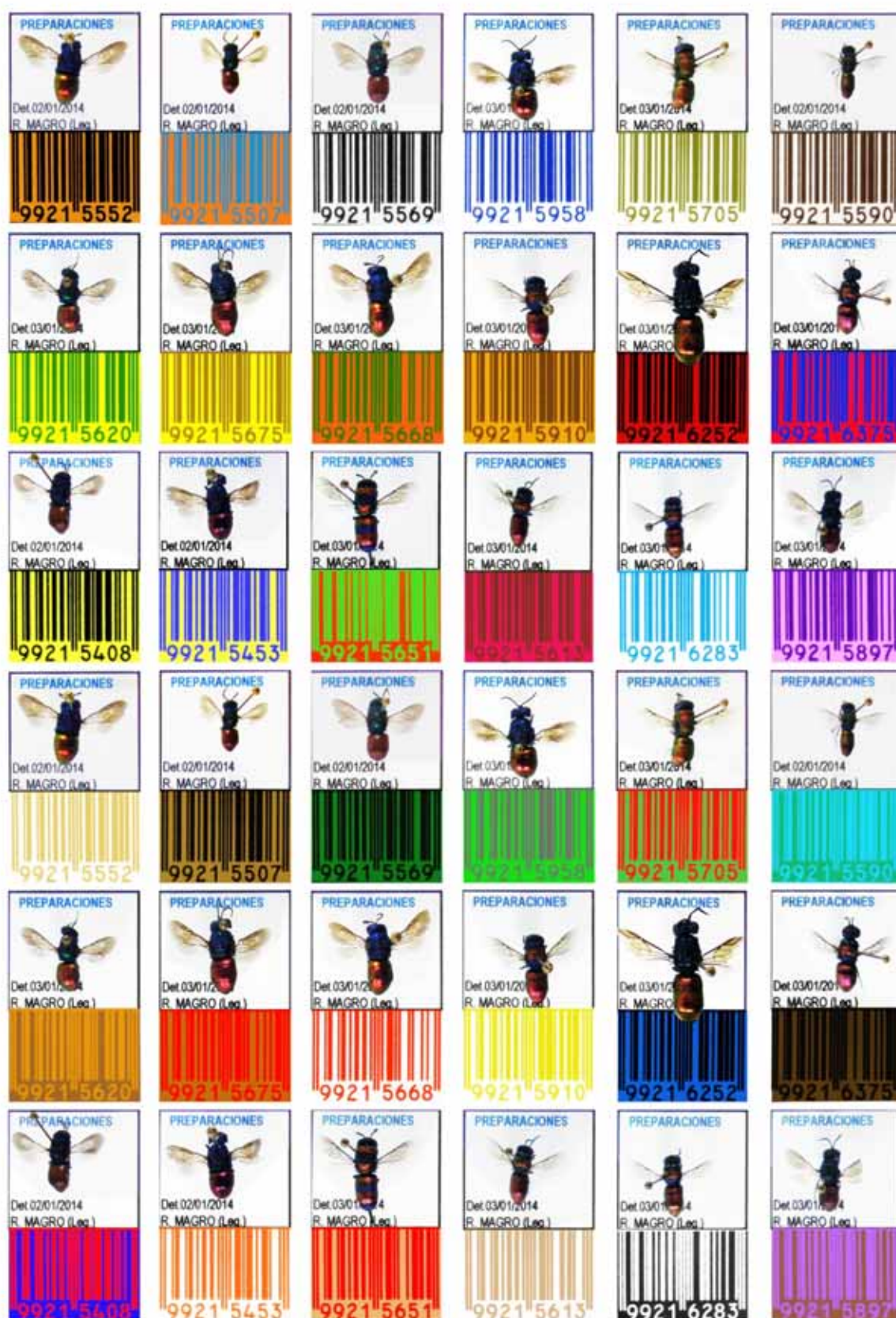
Figuras 54-90: en las tres primeras filas, figuras 54 al 71 se muestran combinaciones de color que pueden ser leídas por un lector. En las tres últimas filas, figuras 72 a 90 las combinaciones de color no legibles.
