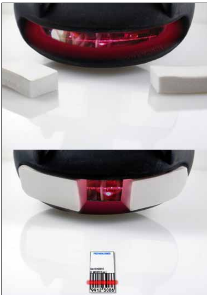
Figura 105: limitación física por medio de sendos pedazos de espuma del haz de barrido en el cabezal del lector de códigos de barras 1D. Esta apertura es la más adecuada para la lectura de micro-etiquetas y para la distancia de barrido sobre el cristal de una caja entomológica de 50 a 70 mm de altura. Para la adquisición y decodificación de códigos más anchos se tienen que extraer los tramos de espuma como se muestra en la fotografía de la parte superior. Nótese en ésta que el haz queda fuera de campo en el gráfico al haberse inclinado ligeramente el cabezal lector de la pistola hacia la parte superior del eje en sentido vertical.
