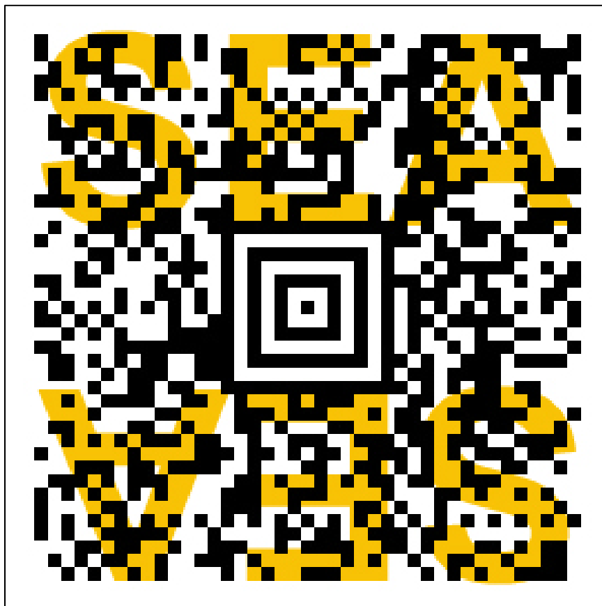
Figura 95: código AZTEC con marca de agua “SEA”. Es un ejemplo límite de color de la impronta bajo el símbolo, pero se puede decodificar.
