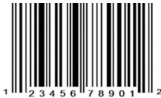
Figura 46: es el sistema de códigos de barras 1D más utilizado en Norteamérica desde el año de 1972. Está formado por 12 dígitos. Es similar al EAN13 pero con una menor distribución universal. El primero adquiere características cosmopolitas en su distribución. Tiende a sustituirse por EAN13.
