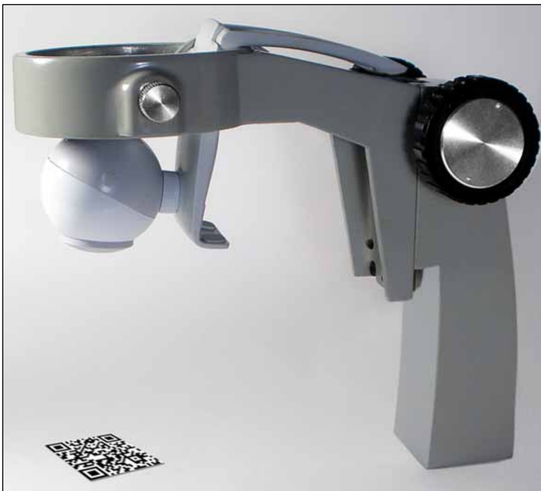
Figura 106: soporte improvisado para la lectura de códigos por medio de una cámara Web que se conecta al computador.
