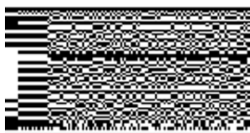
Figura 22: es el más viejo de los símbolos de dos dimensiones. Es un código propietario. Consiste en un patrón de matriz. Los marcadores de la parte inferior del lado y a través de la parte superior de la tira contienen la información de la alineación para los lectores de código y aseguran integridad de datos. Es necesario un lector especial.
