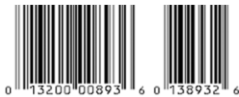
Figura 47: utilizado en artículos muy pequeños. Formado por 8 dígitos. Se trata de un código UPCA reducido por medio de un sistema llamado "supresión de ceros". Para micro-etiquetas y entomología pudiera ser muy útil por su tamaño. La diferencia entre EAN8 y UPCE es que el primero obliga a separar la cadena numérica mientras el segundo puede mantenerse en una única cifra. El único inconveniente del UPCE reside en que no es tan universal y con el tiempo ha tendido a sustituirse por EAN8, estando menos difundido en la actualidad dado que es un código muy antiguo.
