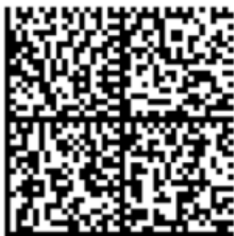
Figura 21: es una simbología 2D bidimensional de matriz con módulos acomodados en un patrón cuadrado o rectangular. Posee patrones de redundancia para la recuperación de errores. En función al nivel puede almacenar mayor o menor número de caracteres. Al mismo tiempo, la longitud de la información codificada depende de la dimensión del símbolo utilizado. Para labores entomológicas puede ser útil cuando es necesario un código de pequeño tamaño y cuadrado. Léanse los comentarios en el apartado correspondiente sobre la utilidad entomológica del MICROQR puesto que son igualmente aplicables al código DATAMATRIX, pero en comparación con el código MICROQR, en el mismo tamaño y nivel de recuperación, DATAMATRIX puede contener mayor cantidad de información (anexo I, tablas, II, III, IV y V).
