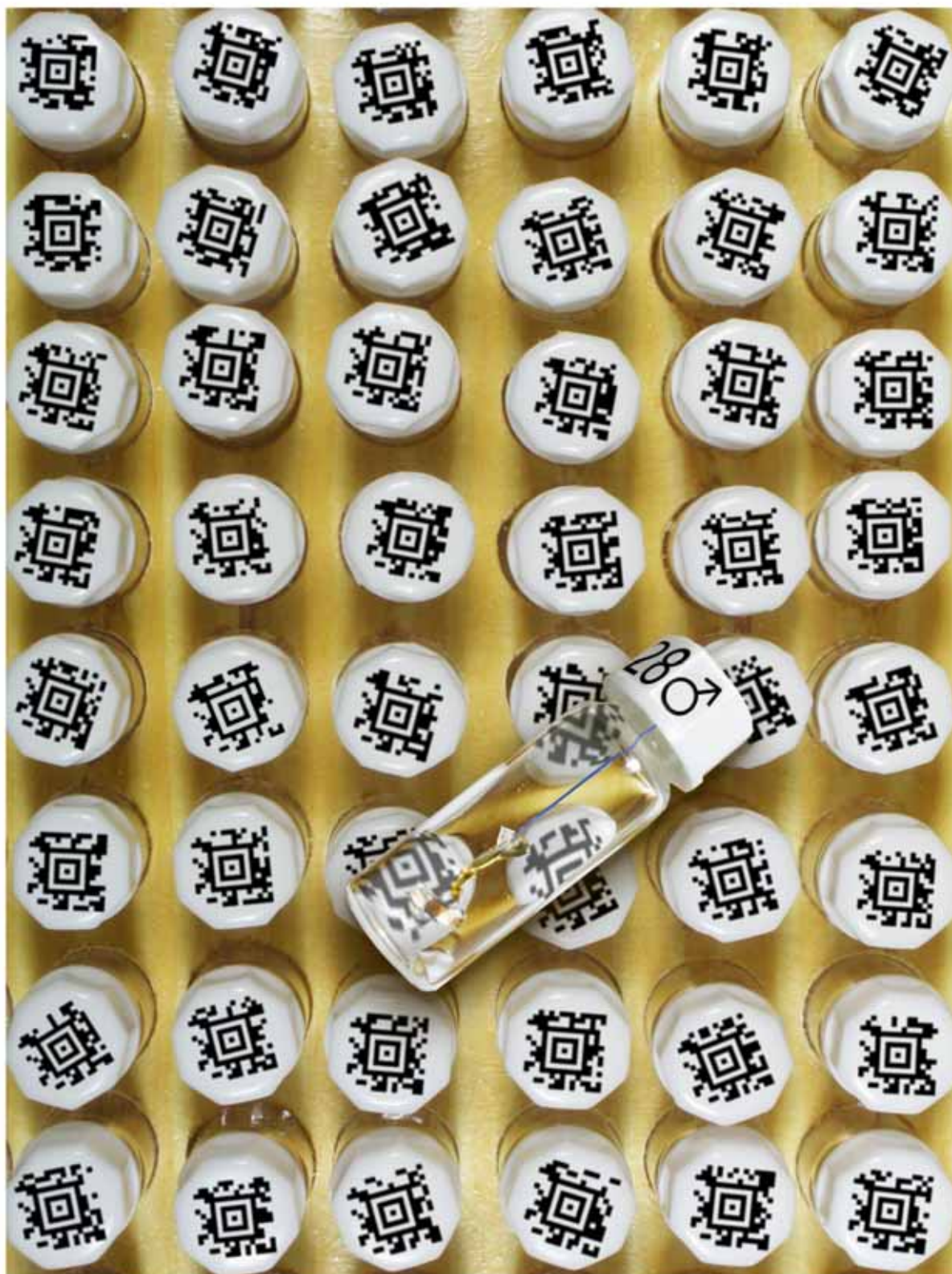
Figura 170: detalle de una caja de frascos, con preparaciones microscópicas de vesicas evaginadas con la técnica del silopreno. Se han utilizado etiquetas con código AZTEC utilizando el sistema de calcas. Obsérvese que no se ha prescindido de la numeración.
