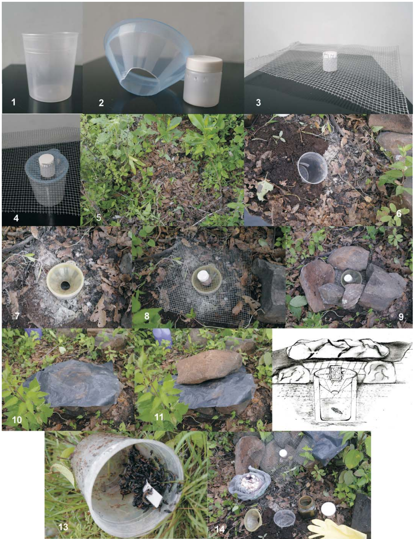
Fig. 1. Bote plástico de 1000 ml. Fig. 2. Embudo y perforaciones en el bote plástico de 50 ml. Fig. 3. Malla metálica con el bote plástico de 50 ml ajustado en el orificio hecho. Fig. 4. Estructura básica de la necrotrampa. Fig. 5. Lugar elegido para la instalación. Fig. 6. Bote de plástico 1000 ml enterrado en el hoyo escavado. Fig. 7. Bote de plástico con alcohol, ácido acético glacial y el embudo puesto. Fig. 8. Estructura básica de la trampa enterrada. Fig. 9. Disposición de las rocas asegurando la malla. Fig. 10. Plástico cubriendo la necrotrampa. Fig. 11. Disposición de la malla asegurando el plástico y cubriendo la necrotrampa. Fig. 12. Vista lateral de la trampa ya instalada, creando un "refugio". Fig. 13. Recolección selectiva de estafilínidos necrócolos. Fig. 14. Materiales utilizados en campo para la instalación de la necrotrampa y recolección de estafilínidos necrócolos.
